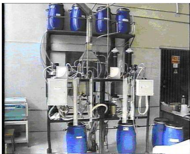
Рис. 5. Экспериментальная установка получения особо чистого \text{Li}_2\text{CO}_3 .
